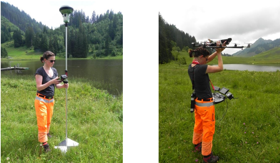
Abbildung 8: Damit die Aufnahmen mit Koordinaten versehen werden konnten, mussten acht Markierungen am Boden gesetzt werden. Diese Markierungen mussten genau vermessen werden (links). Mit der Drohne (rechts) wurden mehrere Bilder aufgenommen und am Schluss zu einem einzigen Bild zusammengefügt, dem Orthophoto.
