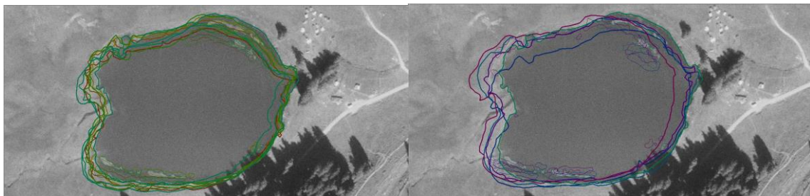
Abbildung 19: Aufteilung der Daten der Langzeitstudie. Links sind alle Daten ab 1978 und rechts sind die Flächenumrandungen zwischen 1935 und 1978. Kurz nach 1978 wurde eine Wasserschwelle gebaut, welche den Wasserstand konstant hält. Diese Erneuerung ist gut erkennbar in der Übereinstimmung der Flächen.
