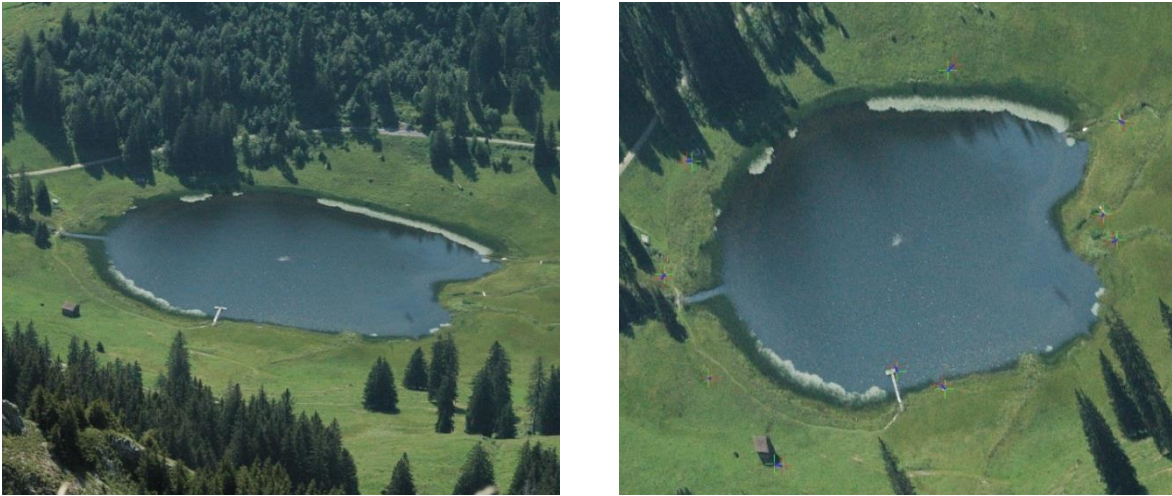
Abbildung 10: Aufnahme vom 25 Juli 2014. Der See (links) ist verzerrt und kann deshalb in diesem Zustand nicht ausgewertet und verglichen werden. Diese Aufnahme wurde im Programm georeferenziert. (rechts). In diesem Schritt wurden die 10 Punkte der Aufnahme jeweils einem Punkt zugeordnet.
