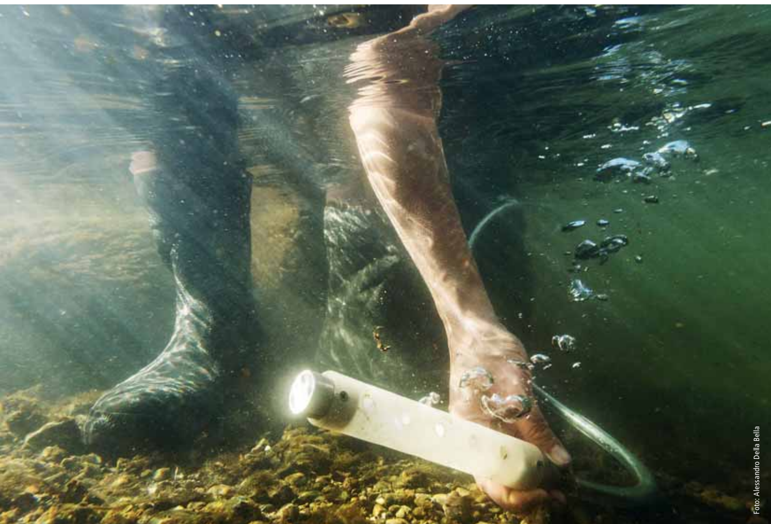
▼ Abbildung 4: Installieren eines aktiven Probennehmers. Für eine aussagekräftige Messung ist die Probenahme von entscheidender Bedeutung.
