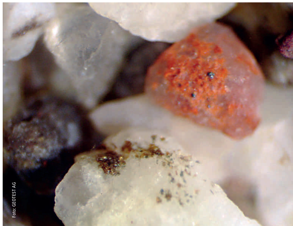
▼ Abbildung 4: Bei dieser Sandprobe aus der SABA Ristet sind schwarze Schmutzpartikel (Autoreifen- oder Strassenabrieb) auf Sandkörnern zu sehen. Vergrößerung ca. 100x, Auflicht.
