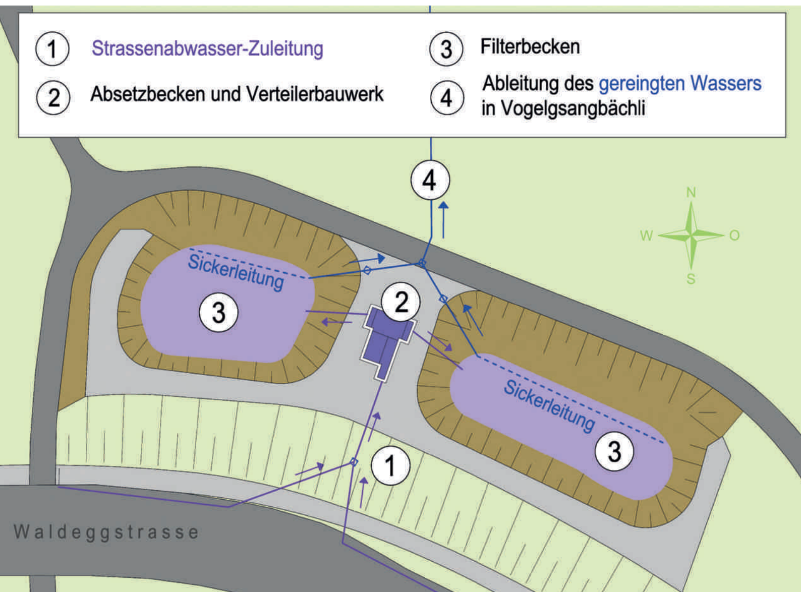
▼ Abbildung 3, unten und oben rechts: SABA Ristet im Kanton Zürich, Übersichtsplan und Blick auf Retentionsfilterbecken, das mit Schilf bepflanzt ist.
